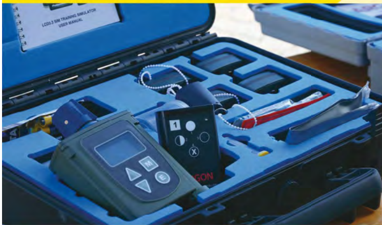
Das ABC-Simulationssystem ARGON ist eine Live-Simulation und ermöglicht das Detektieren von Kampfstoffen ohne Gefahr für die Übenden und die Umwelt. Foto: Bundesheer/Sascha Harold
